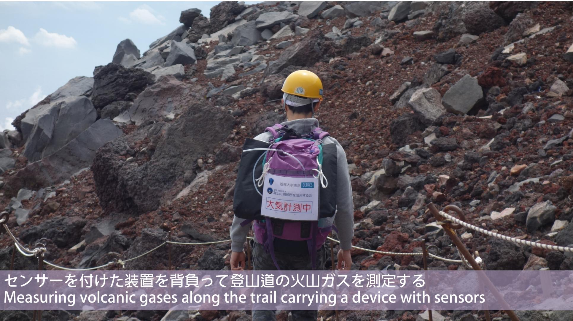
センサーを付けた装置を背負って登山道の火山ガスを測定する
